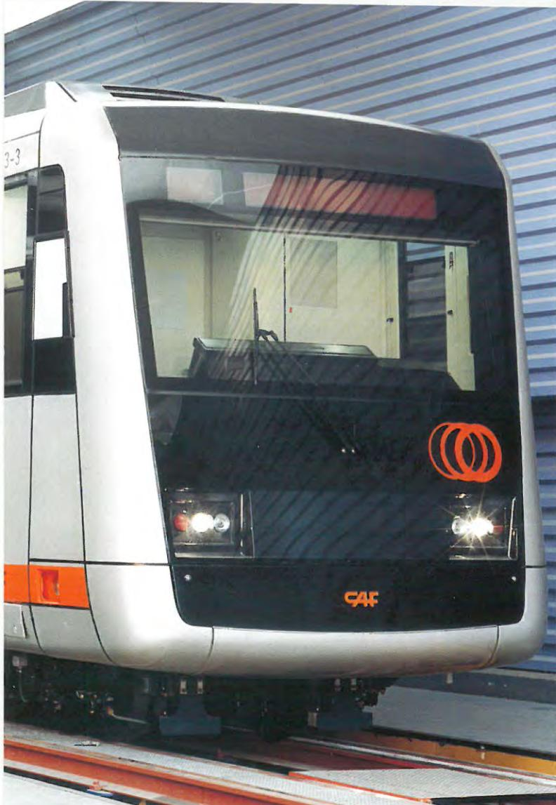
CAF, bajo diseño propio, está construyendo las nuevas Unidades S/550 para la Línea 2 del Metro de Bilbao. Conceptualmente, como en la serie anterior, están formadas por cuatro coches motores de los cuales, los dos extremos disponen de cabinas de conducción. Incorporan importantes mejoras técnicas tanto en los equipos, de nueva generación, como en los sistemas de información, comunicación y protección.
