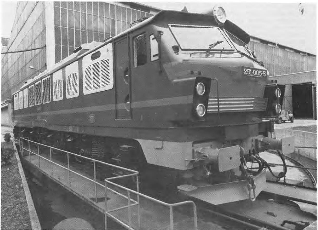
LOCOMOTORA ELECTRICA CHOPPER BBB A 3.000 V. DE 4.650 Kw.
